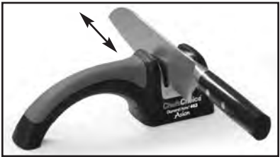
Figura 1. Coltello in fase 1. Effettuare passaggi di affilatura avanti e indietro esercitando una pressione moderata verso il basso (vedere il testo).
